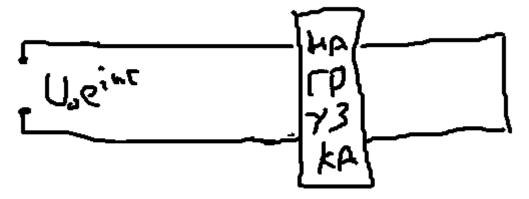
В роли нагрузки в середине цепи может выступать как и действительно полезная нагрузка, вроде, например, лампочки, провода от которой идут к двум паралелльным линиям, но и любая неоднородность, как, например, изменение геометримеческих параметров линии (уменьшение/увеличение площади сечения).
